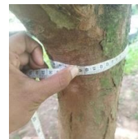
Gambar 3 7 Mengukur Diameter Pohon
